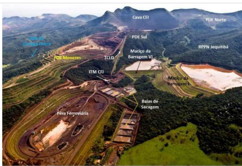
Segundo informações fornecidas pela Vale S.A., a Barragem I estava situada no Complexo Paraopeba, em torno das coordenadas UTM: 7.775.080N / 591.955E. A Barragem I tinha como finalidade a contenção de rejeitos gerados no processo de beneficiamento do minério de ferro da Mina Córrego do Feijão lançados por meio de “spray-bars” posicionados ao longo da crista da estrutura. Todavia, seu reservatório também serve para clarificação da água a ser extravasada para a Barragem VI.
